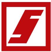
Possibilité d'autoclavage (°C max.) 121 °C
