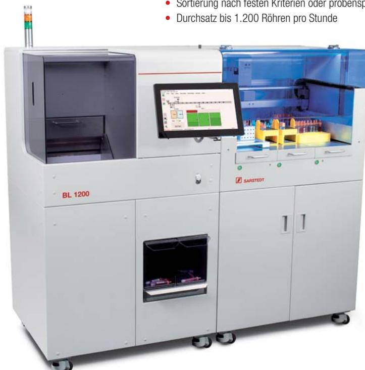
Der Bulk Sorter BL 1200 bildet die Basis für die schnelle und effiziente Probeneingangserfassung und -sortierung. Die geschlossenen Probenröhren können manuell oder über das Tempus600®-System zugeführt werden. Das Kamerasystem registriert den Röhrentyp, der Scanner liest die Proben-ID, so dass die Sortierung zuverlässig nach festen Kriterien oder den aus dem LIS gelieferten Informationen erfolgen kann.
