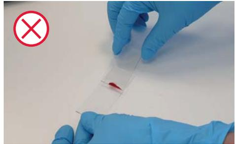
Der Blutstropfen verteilt sich nicht gleichmäßig entlang der Kante des Objektträgers. Ursache: Der Objektträger liegt nicht plan auf oder die Druckverteilung ist ungleichmäßig.
