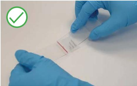
Ein zweiter Objektträger wird vor dem Blutstropfen aufgesetzt. Der ausstreichende Objektträger wird zurück zum Blutstropfen gezogen, bis das gesamte Blut entlang der Kante verteilt ist.
