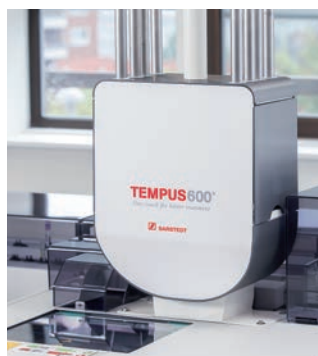
Пробы поступают в модуль подключения Tempus600® к автоматизированным решениям многих производителей или в ручное приемное устройство в лаборатории для доступа (оператором, лаборантом).
