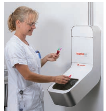
Les échantillons sont reçus dans le module de connexion Tempus600® ou dans le plateau de réception du laboratoire.
