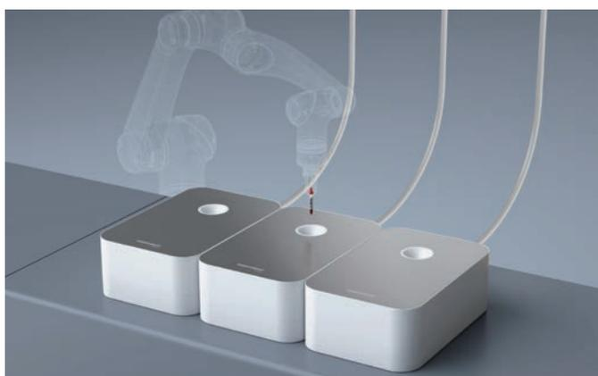
検体はロボットアームやその他の自動挿入装置によって個別に挿入されます。
