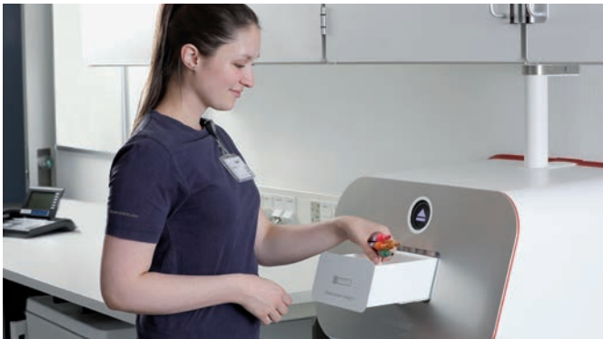
Carico per un massimo di 25 campioni alla volta
