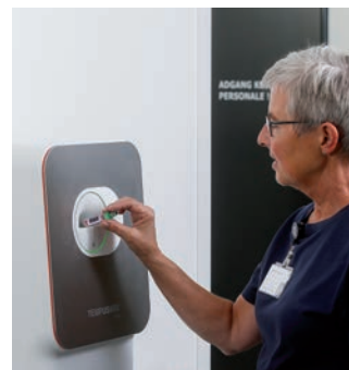
Skúmavky so vzorkami sa vložia do vkladacieho otvoru stanice Vita.
