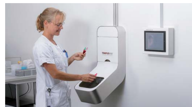
Vzorky jsou přenášeny do přijímacího nosiče, kde jsou přijaty.
