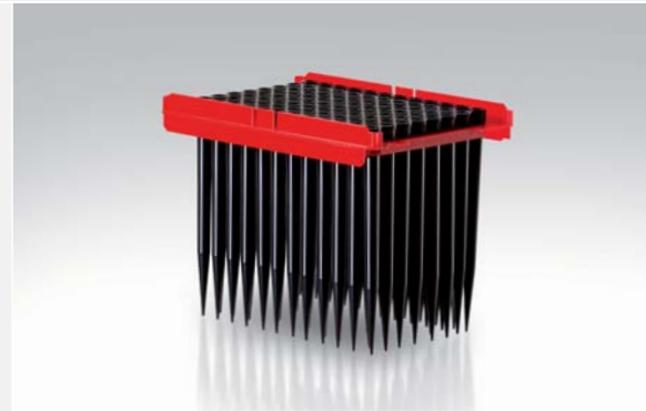
Doluluk seviyesinin hassasiyetle ölçülmesi ve kontaminasyonsuz pipetleme için iletken, kullan-at uçlar
