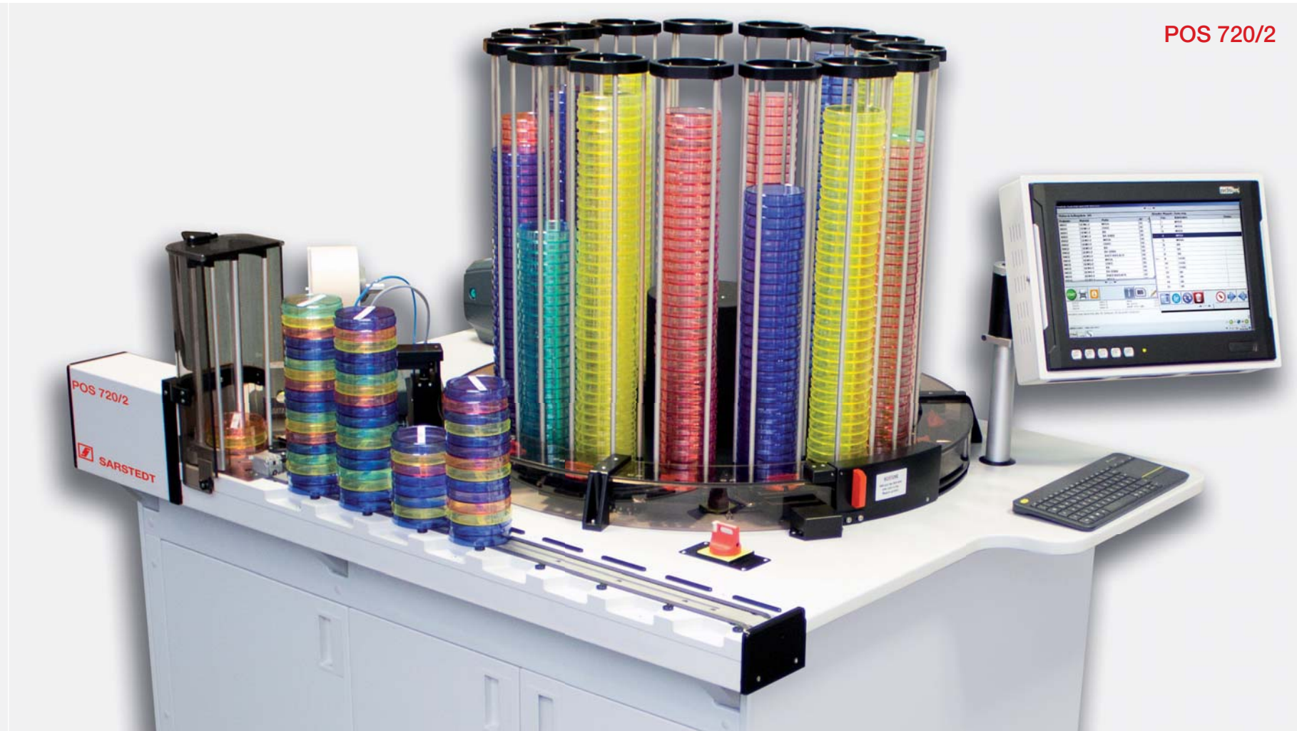
存放架最多可容纳 8 叠（每叠 18 个）培养平板
