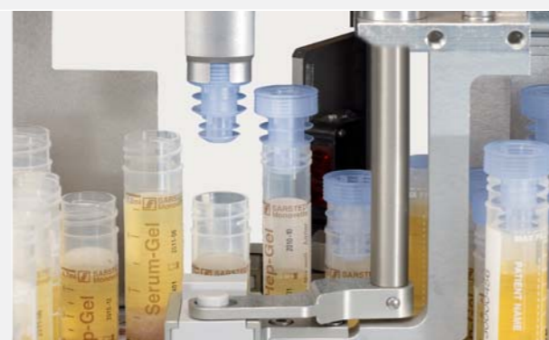
Надевание пробок для архивирования
