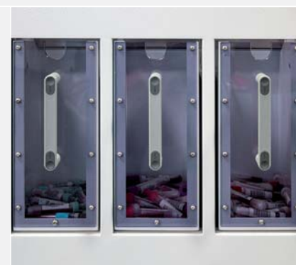
Rozdelenie do cieľových boxov v prípade HCTS2000 MK2
