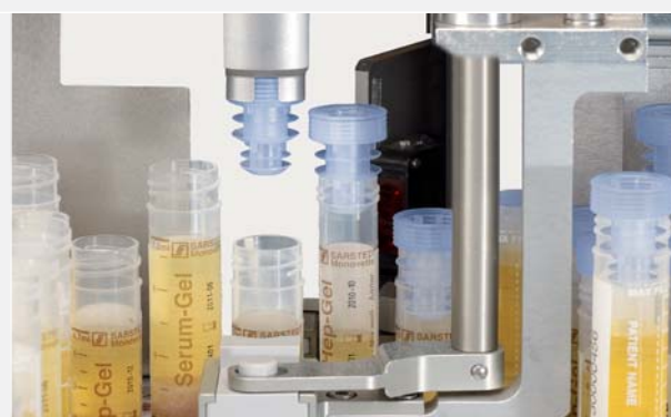
Ponowne zakręcanie: korek archiwizacyjny
