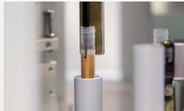
Aspiração da amostra no recipiente primário
