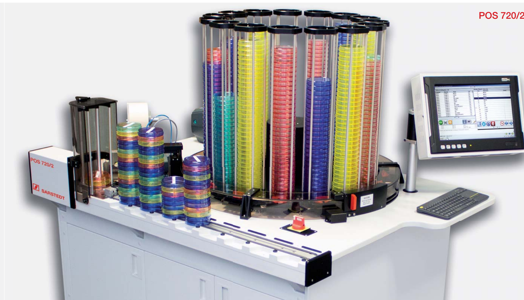
Compartiment pentru până la 8 stive cu 18 plăci fiecare
