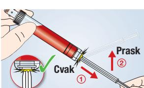
4. Z dôvodu bezpečnosti počas prepravy a centrifugácie sa piest uzamkne v spodnej časti skúmavky S-Monovette® (cvak) a tialho piestu sa odlomí (prask).
