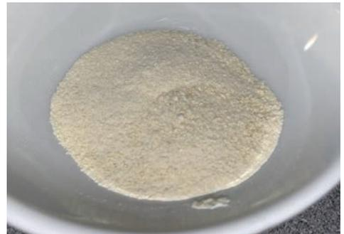
Harnstein nach Dokumentation von Anzahl, Trocknung und Zermahlung zur Vorbereitung für die Infrarotspektrometrie-Untersuchung
