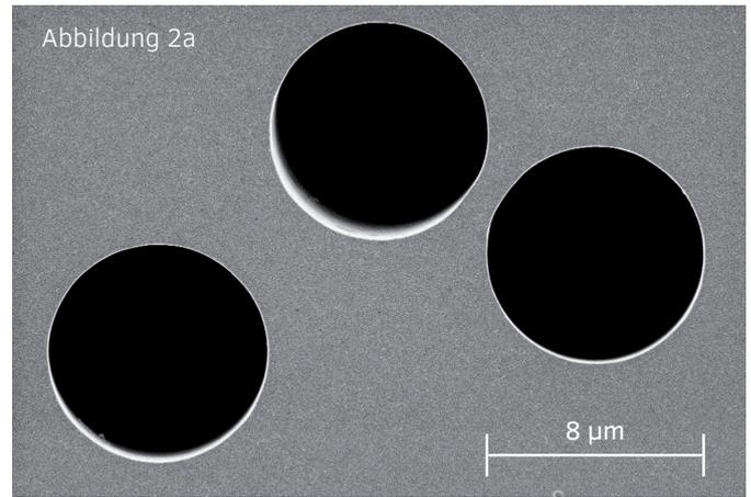
Elektronenmikroskopische Aufnahme zeigt die gleichmäßige Verteilung und konstante Größe der Poren.
