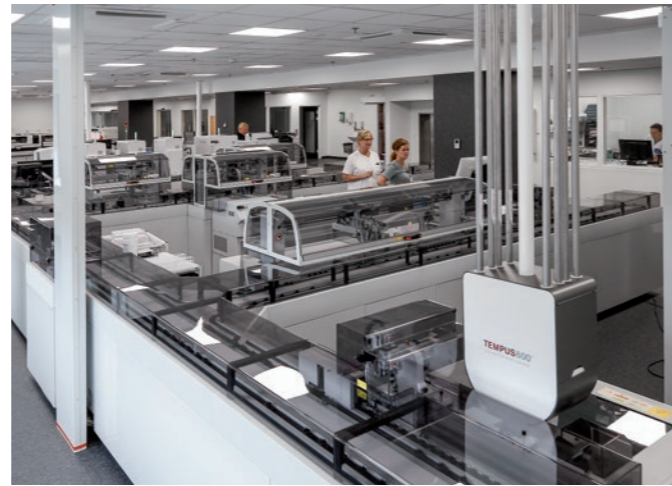
Tempus600® bağlantı modülü, numune tüpleri için tek dokunuşla çalışan otomatikleştirilmiş bir taşıma sisteminin parçası olarak daha az işlem, numune tüplerinin el değmeden işlenmesi ve genellikle daha hızlı ve güvenli taşıma sağlama gibi bir dizi avantaj sağlar.
