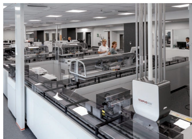
Pripájací modul Tempus600® ako súčasť automatizovaného systému manipulácie jedným dotykom so skúmavkami na vzorky poskytuje širokú škálu výhod, ako napríklad menej pracovných postupov, bezdotykové narábanie so skúmavkami na vzorky a vo všeobecnosti rýchlejšiu a bezpečnejšiu manipuláciu.
