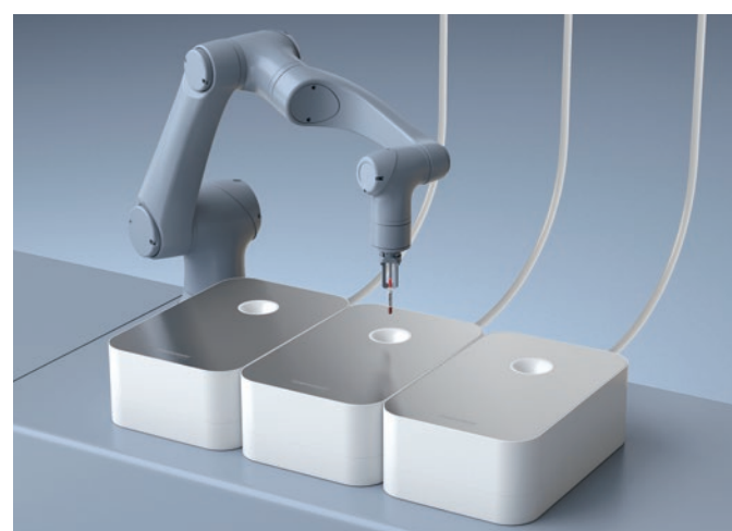
O Tempus600® Solus é usado para redistribuir amostras após a desembalagem. Se for necessário mais de um destino, basta adicionar um número equivalente de estações de envio.
