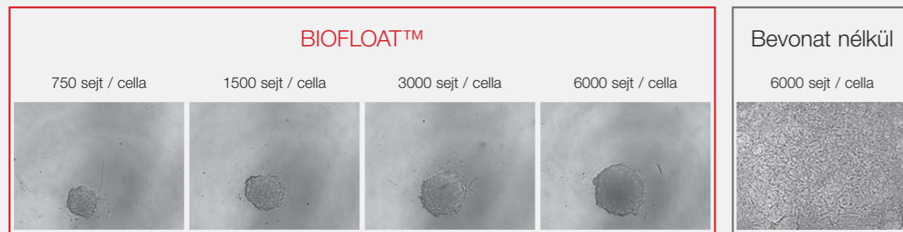
1. kép: Fibroblaszt sejt vonalak sejtjeit (3T3) különböző sejtszámokkal BIOFLOAT™ sejt kultúra-lemezre vetették el. Kontrollként egy bevonat nélküli lemez szolgál. Az eredményeket három nap után mikroszkóppal dokumentálják. Világosan látható, hogy a BIOFLOAT™ segítségével sikeres volt a szferoidképződés. Ezenkívül a szferoid mérete a sejtszám / cella segítségével befolyásolható. Ezzel ellentétben a bevonattal nem rendelkező felületen nem lehet fibroblasztokat megkötni és nem képeznek szferoidokat.
