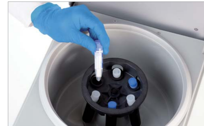
Zentrifugation von Salivetten zur Speichelgewinnung.
