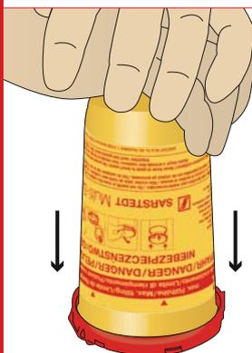
Poser le couvercle sur une surface stable. Appliquer la partie inférieure de la boîte à déchets par le haut sur le couvercle. Emboîter fermement la partie inférieure sur le couvercle de manière à ce que le bord externe de la partie inférieure s'enclenche de manière audible et visible sur toute sa périphérie.
