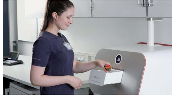
Tek seferde en fazla 25 numuneyi alabilen çoklu giriş kanalı.
