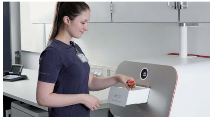
多重进样口，最多可同时送入 25 个样本
