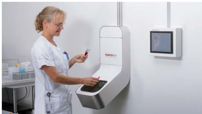
Les échantillons arrivent dans le plateau de réception où ils sont récupérés.
