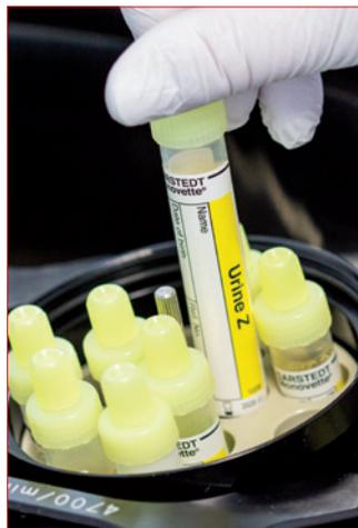
Die direkte Verwendung als Zentrifugenröhre verkürzt die Analysenzeit. Nachdem der Überstand dekantiert wurde, kann der Kolben wieder zurück nach oben geschoben und das Sediment hygienisch entnommen werden.
