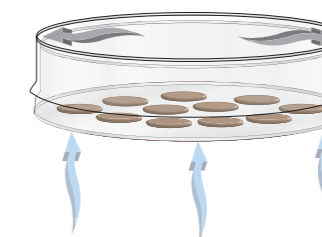
Obr. 4 V konvenčných nádobách na bunkové kultúry nie je možná výmena plynov cez polystyrénové alebo sklenené dno.
