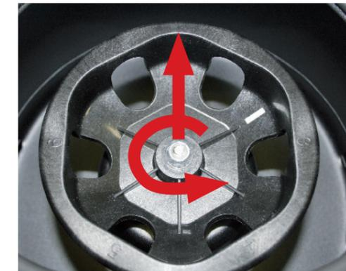
Der Einbau des Rotors erfolgt in der umgekehrten Reihenfolge.
