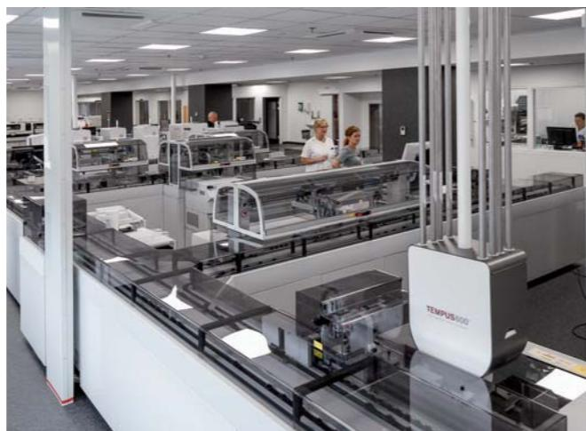
Tempus600<sup>®</sup> 连接模块作为样品自动化一键式处理系统的一部分，可带来诸多好处，比如减少了工作流程，不需手动处理样品种管，处理更迅速、可靠。
