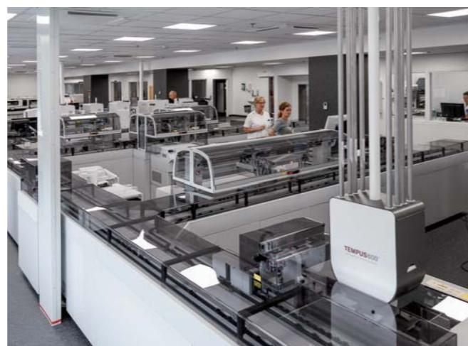
Propojovací modul Tempus600® jako součást automatizovaného systému manipulace jedním dotekem pro zkumavky na vzorky poskytuje širokou řadu výhod, například zjednodušení pracovních postupů, bezdotykové zacházení se zkumavkami se vzorky a celkově rychlejší a bezpečnější manipulaci.
