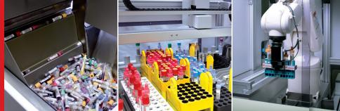
Transferencia automática de muestras del Bulk Loader a la línea de análisis
