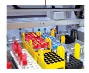
Las muestras no destinadas a la línea de laboratorio se descartan aquí, se introducen en gradillas y se ponen a disposición para la extracción manual.
