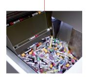
El módulo Bulk Loader sirve para el reconocimiento del tipo de tubo y el registro de muestras.
